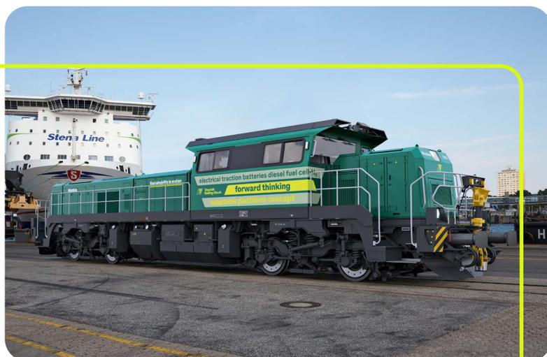
La Modula combine les caractéristiques d'une locomotive de ligne avec celles d'une locomotive de manœuvre classique, et l'accent est mis ici sur la flexibilité des sources d'énergie. Le profil d'application du client permet de combiner deux sources d'énergie pour obtenir une seule variante.
